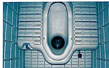
便器は奇麗な真水で洗浄します。踏み台は真水60ℓが収納出来ます。便槽の臭いをシャットアウトする無臭フラッパー付
